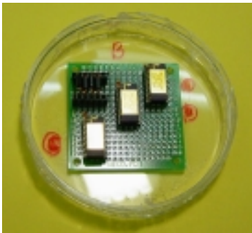
그림 8. 제작된 핵연료 교환기 방사선량 측정용 반도체 센서모듈(A, B)
