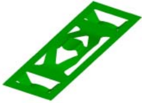
그림 2. 최적화 H형 지지격자의 스프링판 형상
