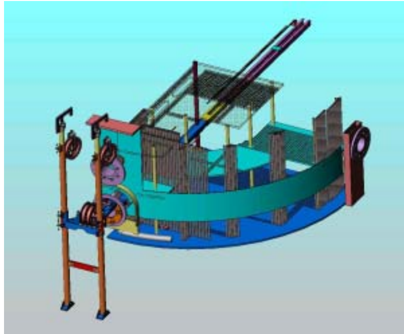
그림1 증기발생기 모형에 설치된 세정장비
