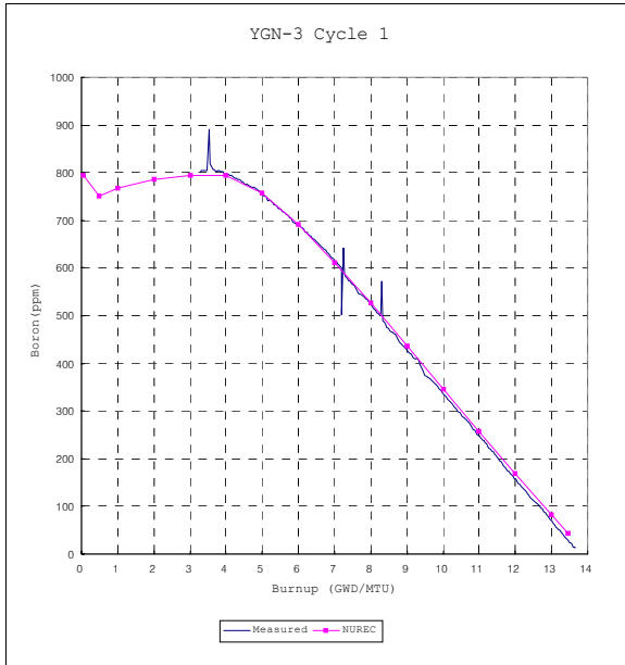
(1) 영광 3호기 1주기 임계붕산농도 계산 결과 (2) 영광 4호기 1주기 임계붕산농도 계산 결과
