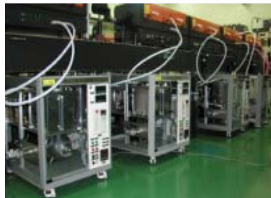
그림 12. 색소용액 순환기의 구성도 및 설치된 순환기 모듈의 모습.
