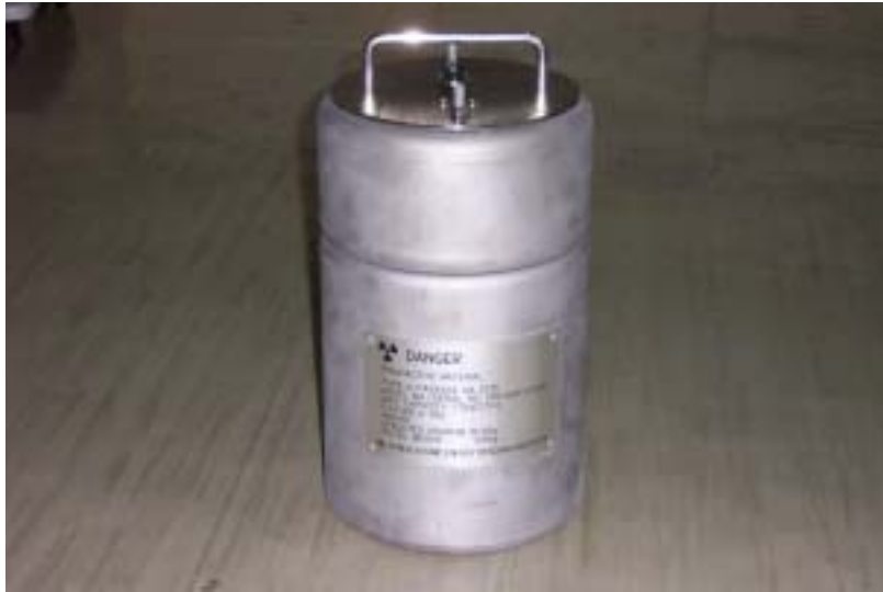
그림 7. 조립 완성된 차폐체 운반용기
