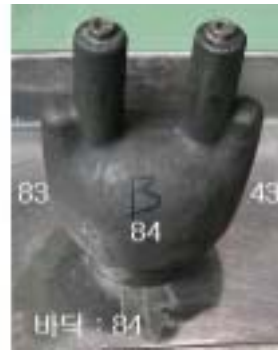
그림 8. 시험 선원 Ir-192 10 Ci 2개를 이용한 방사선 차폐성능 시험 결과
