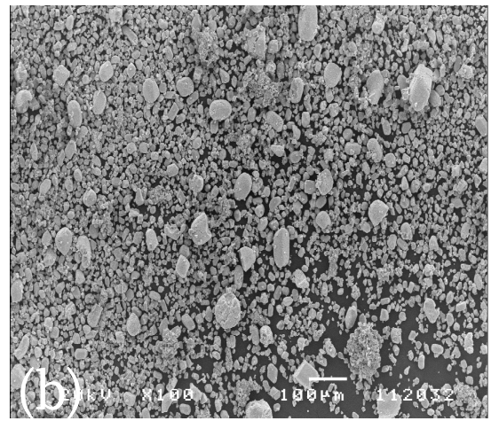
그림 19. \text{U}_3\text{O}_8 분말의 입도 크기 및 형상.
