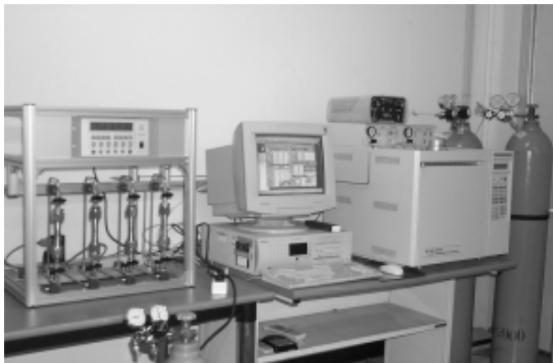
그림 2. The adsorption system of Kr and GC analyzer.
