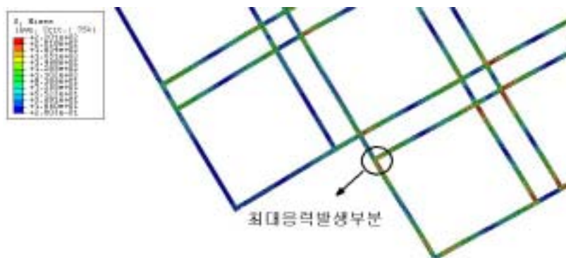
그림 5. 30°회전모델의 바스켓 구조물 von Mises 응력분포
