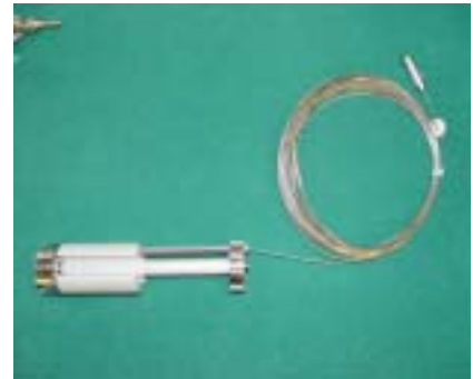
그림 7. Cooling block에 설치된 SPND
