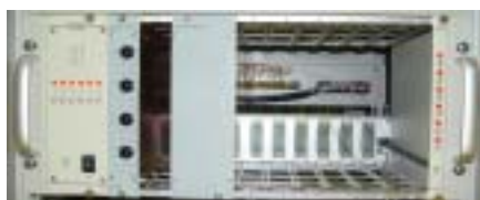
그림 2. 핵연료 제어시스템에 장착된 DC Amplifier 4695A
