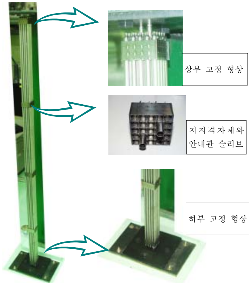
그림 1. 5X5 이중관 지지격자체로 만든 부분 핵연료집합체
