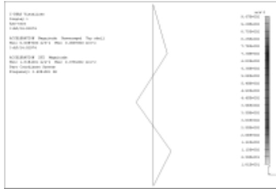
그림 12 시험으로 얻은 1차 진동 모드
