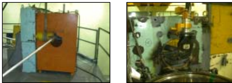
그림 2-10 동위원소조사파이프 세절장치 및 유압절단기를 이용한 세절
