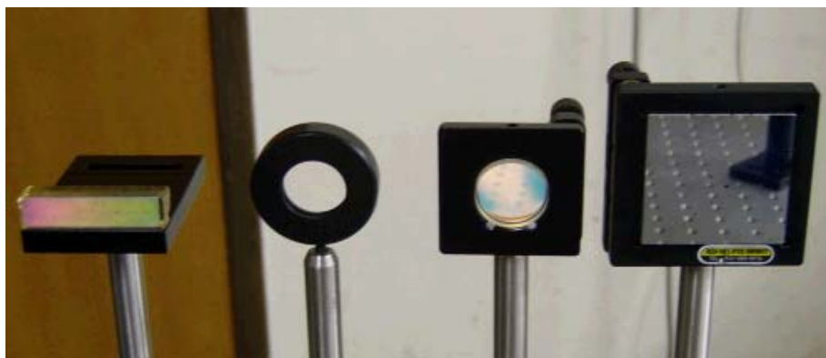
그림 5. 공진기 구성 Optics (왼쪽부터 Grating, Lens, Tuning mirror, Rear mirror)
