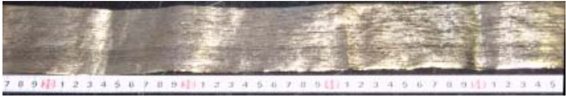
그림 1. 냉각롤 구조법에 의해 연속적으로 제조된 저농축 우라늄 박판.
