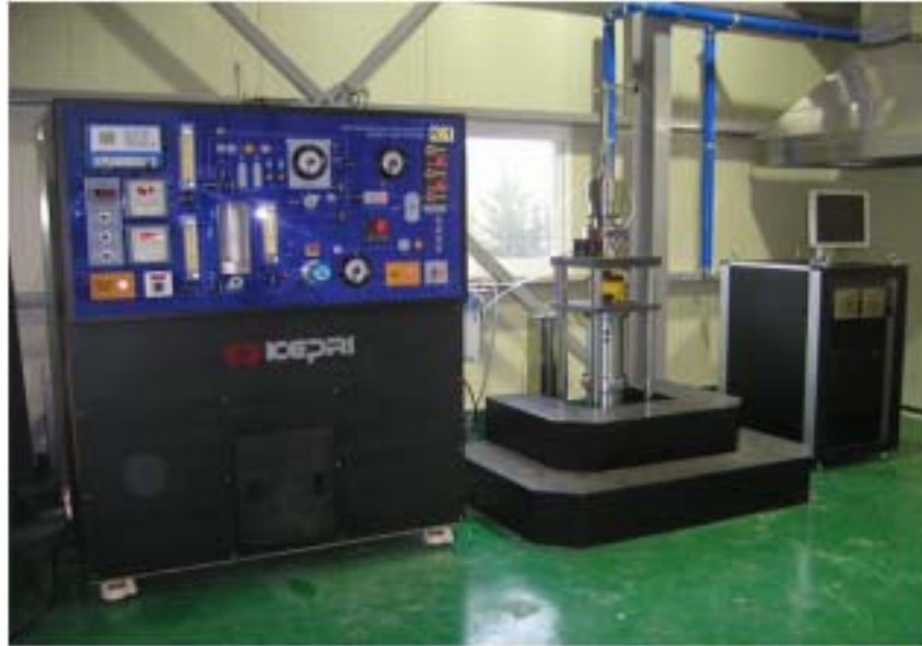
Fig. 5 저주기 S-N 환경피로 실험 장치
