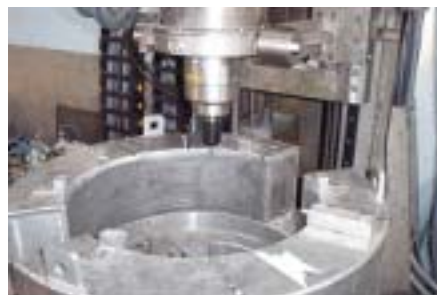
그림 8. NC 코드를 이용한 자동절단 시험
