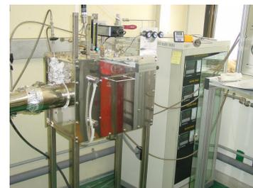
Fig. 1. ZrCl<sub>4</sub> vaporizer.
