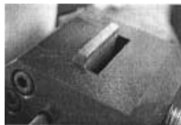
Fig. 4.8. Wedge Type Manual Grip
