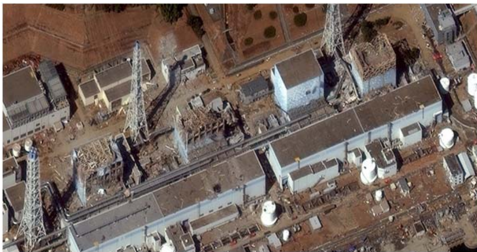
그림 2.3-2. 수소가스 폭발 후의 후쿠시마 제1원전 1~4호기 외부 모습
