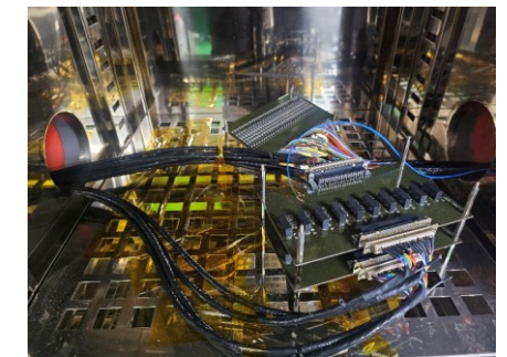
DC-DC Converter 열화 후
