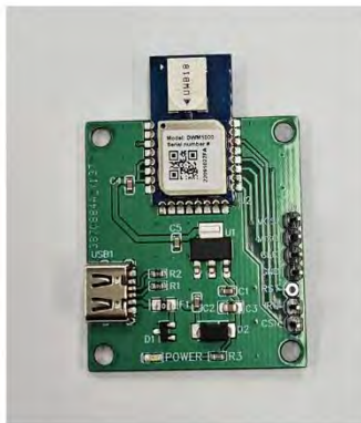
DWM1000 기반 시각화 거버파일(좌) 및 실물 구현 UWB PCB 모듈(우)
