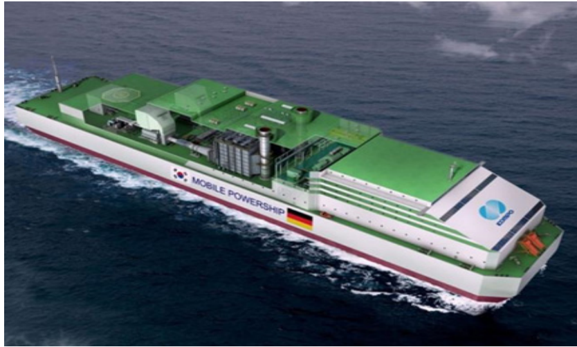
그림 3.2-4 폴라리스 컨소시엄이 개발할 이동식 발전선 개념도
