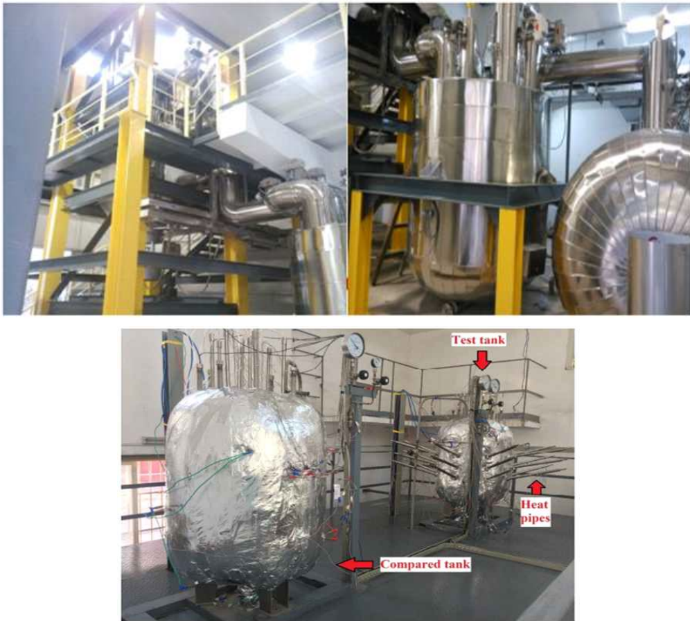
그림 3.2.10 정상, 과도상태의 용융염 온도 거동 평가를 위한 실험장치
