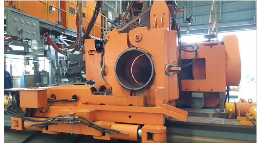
그림 3.1.10 유도가열벤딩 배관 개념 및 제작
