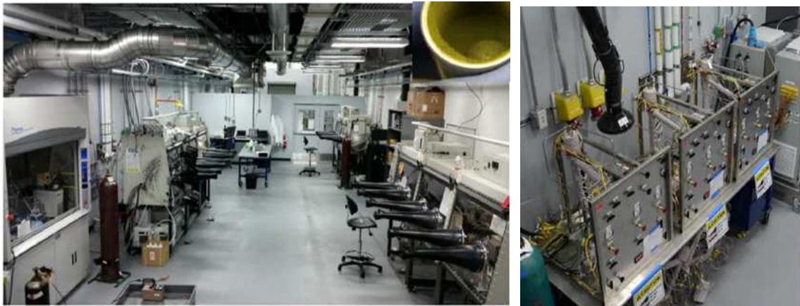
그림 3.2.16 TerraPower사의 용융염 화학실험실(좌)과 부식시험장치(우)
