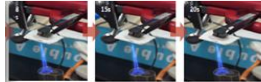
Soldering TE Module using p-PbTeNaAg, n-PbTeBi Legs
