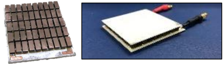
Soldering TE Module using p-PbTeNaAg, n-PbTeBi Legs
