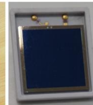
Wire bonding된 Si PIN
